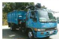
クラムシェル車 積載量:5t(容積:16.1m 3 ) 台数:1台
