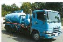
強力吸引車(ダンパー車) 積載量:8.6t(容積:9.9m 3 ) 台数:1台
