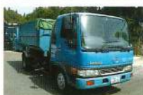
4tフックロール車 積載量:3.1t(8m 3 ) 台数:2台
