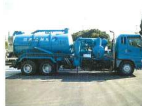
強力吸引車で汚泥も回収可
