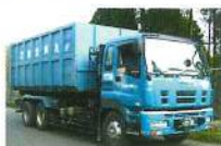
10tフックロール車 積載量:9.6t(27m 3 ,12m 3 ) 台数:3台
