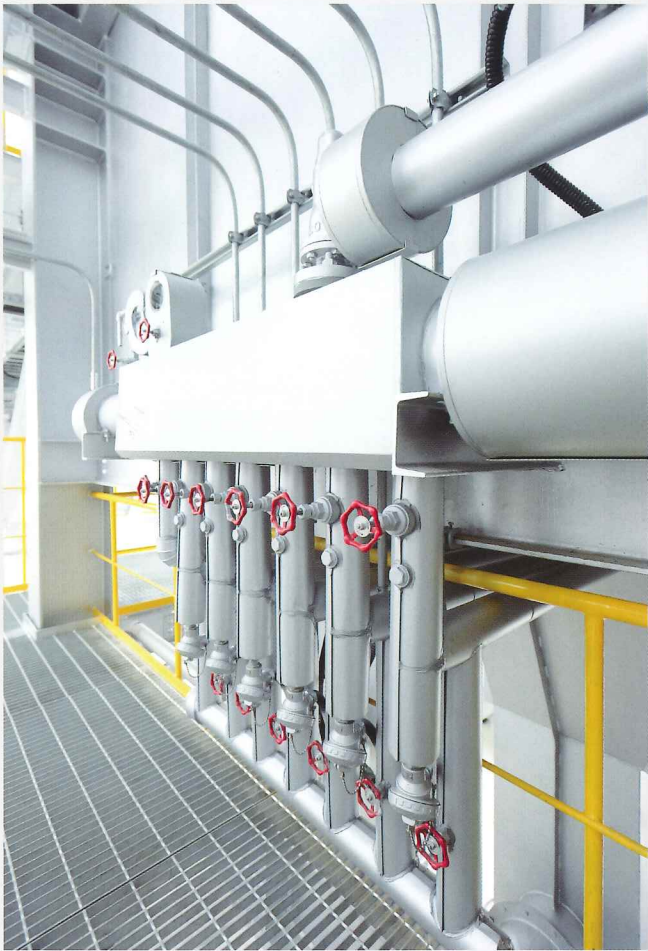
23 ドラム缶炉 金属リサイクルを目的として、主にドラム缶内部に付着した油分を焼却し、金属としてリサイクルします。
