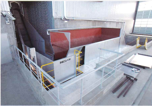
11 破碎施設 形状の大きな廃棄物を破碎して、燃焼効率を上げます。 処理能力は50.4t/日。
