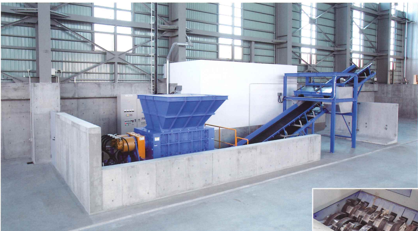
11 破碎施設 形状の大きな廃棄物を破碎して、燃焼効率を上げます。 処理能力は50.4t/日。
