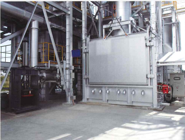
23 ドラム缶炉 金属リサイクルを目的として、主にドラム缶内部に付着した油分を焼却し、金属としてリサイクルします。
